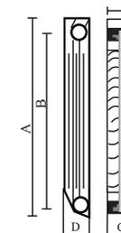
\*Примечание: Тепловой поток указан при нормальных условиях. Тепловой поток (Q) радиаторов при ΔT отличающемся от 70°C, пересчитывается по формуле:  $Q = Q_{\Delta T=70^{\circ}C} \cdot (\Delta T/70^{\circ}C)^n$ , где n=1,30.
